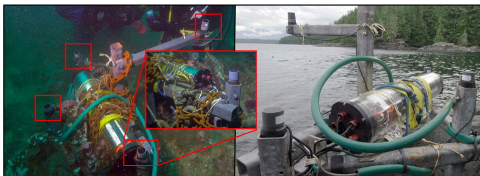
FIG. 2.16 – L'antenne à quatre hydrophones, avec le câble 12 V (vert) connecté à la station de recherche Orcalab.
