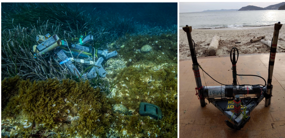
Figure 2.3 : Les antennes de Stochaedes en 2022. Toutes 2 ont été renversées à la dernière pose, suite à un gros temps, ou à une ancre, car nous y avons retrouvé des traces de rouille. (Gauche) Rascas renversée malgré ses 10 kg de masse de plomb. (Droite) Rayol le 26 mars après avoir été renversée.
