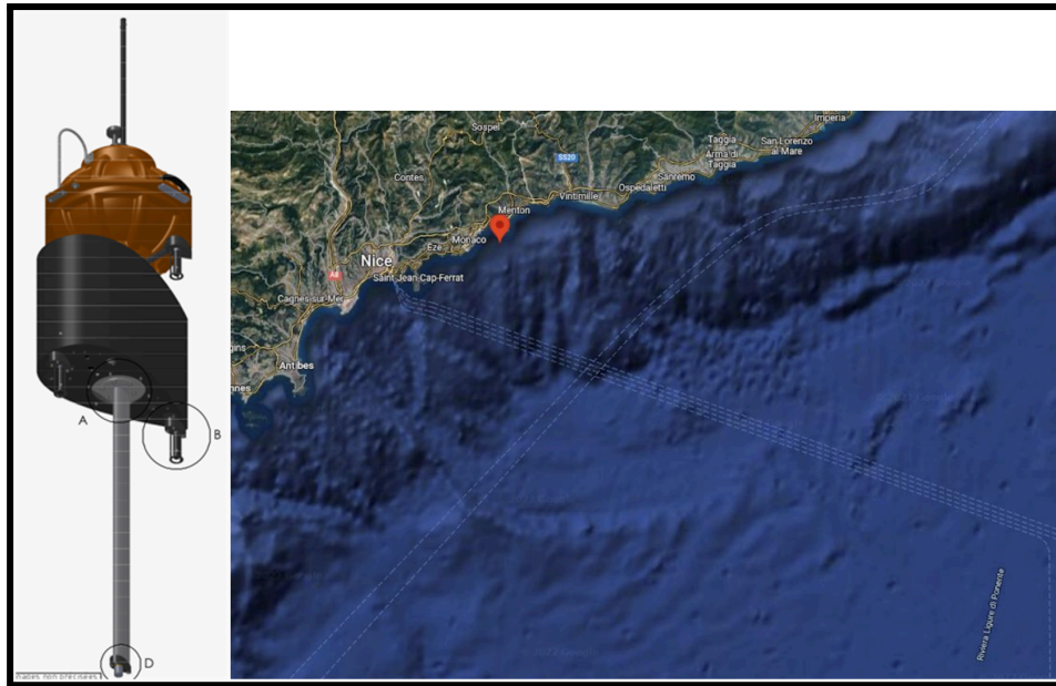
Figure 4.2 : (Gauche) Schéma de la Bouée GIAS BOMBYX-2 à 5 hydrophones et son système de ballast (hauteur totale de 3m). (Droite) Localisation géographique de BOMBYX-2 face aux rails de trafic maritime (en pointillés).
