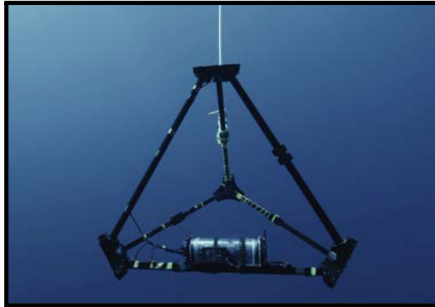
Figure 3.2 : Antenne tétra en immersion par -20 m lors de la mission WhaleWay. Design V. Gies et H. Glotin. Sa version 'penta' intègre un 5 ème hydrophone (crédit F. Sarano / Longitude 181).
