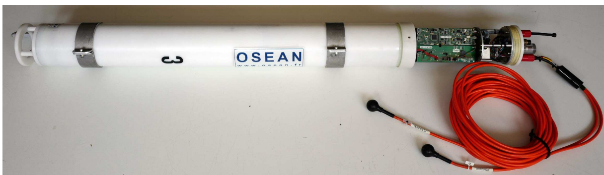
Figure 1 : Le tube de la société Osean avec son enregistreur installé sur Bombyx en 2015 et 2016 et les deux voies équipées des HNI Neptune.
