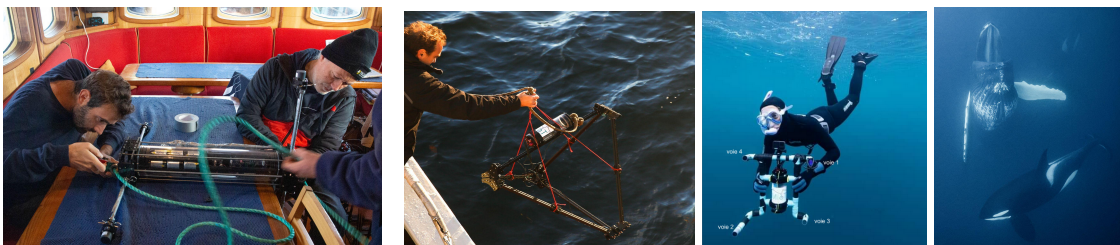
Figure : de Gauche à Droite: antenne LIS IM2NP BOMBYX, 4 voies déployée en 2023 et pour 2024. Mise à l'eau depuis Isbjorn de l'antenne tétraédrique. Antenne de 2021 et 2022 de 4 hydrophones et une GoPro pour le suivi audiovisuel champ proche de chasse et interaction Mn avec Orques. Exemple d'interaction filmée par l'équipe en nage nov. 2022.
